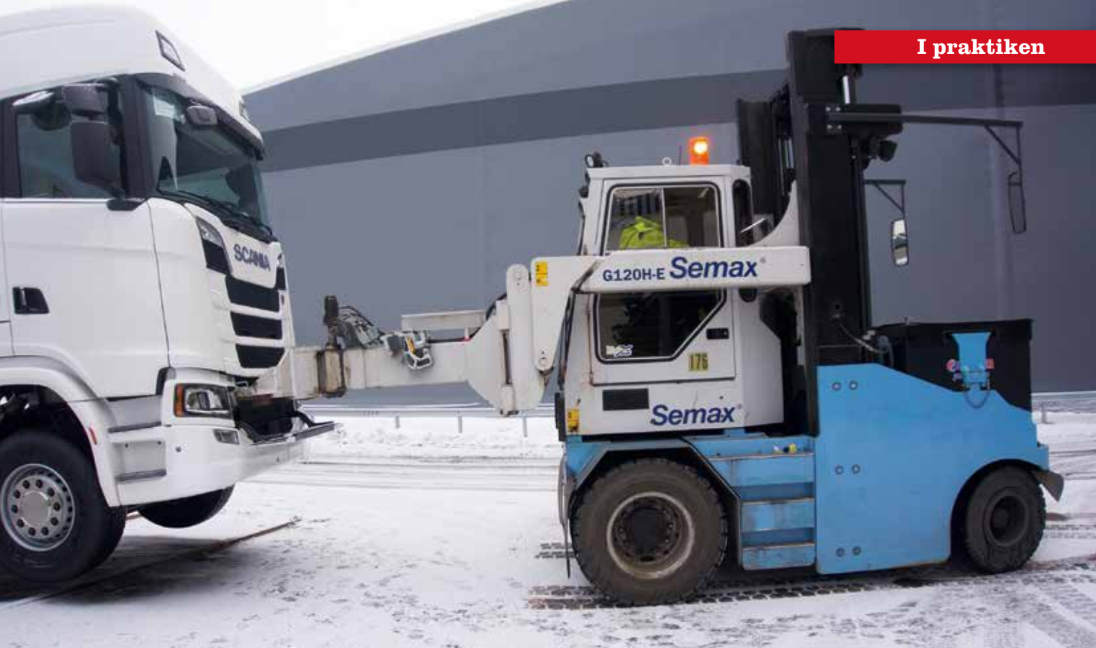
Semaxtruckens lyftok har kopplats till lastbilens bogseringsuttag och hela framaxeln lyfts från marken.
