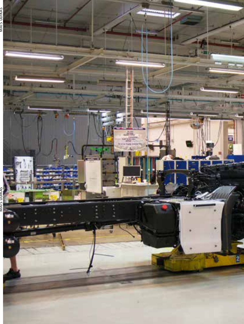
Vid den här stationen sker dockningen, då monteras förarhytten, som levereras från fabriken i Oskarshamn, på lastbilschassit.
